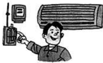
图 4-3 短时间内、不要连续切断或接通电源
